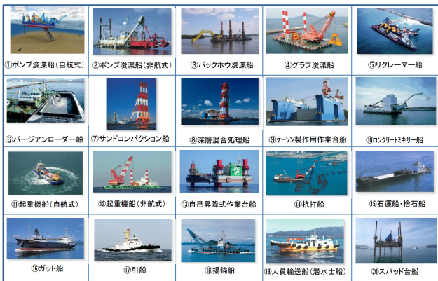
図 1 作業船の外観 (資料提供 (一社) 日本海上起重技術協会)
