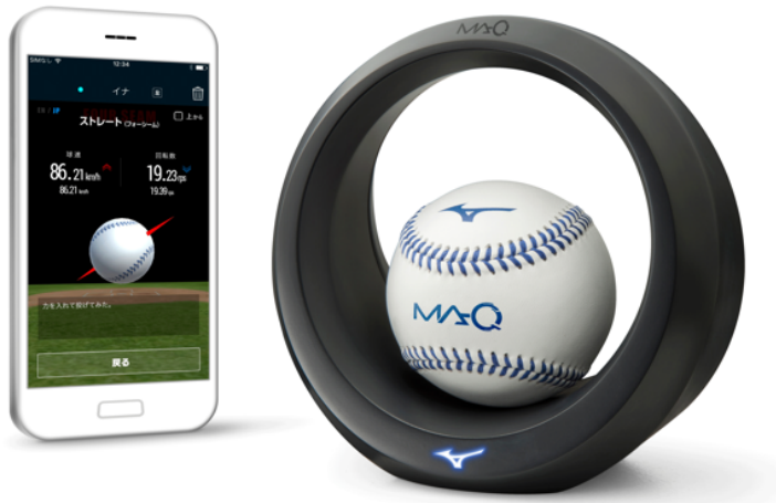
図1 開発された投球データ解析システムの外観
