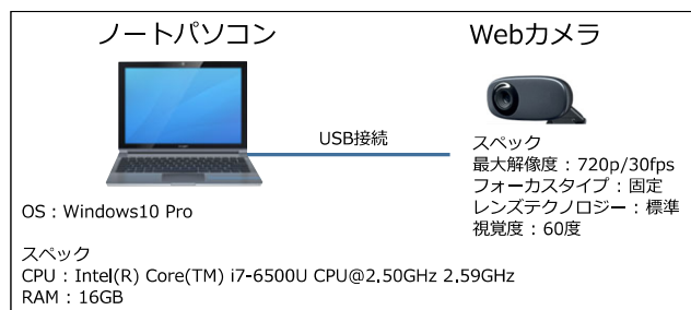
図 2 ハードウェア構成 Fig. 2 Hardware configuration.
