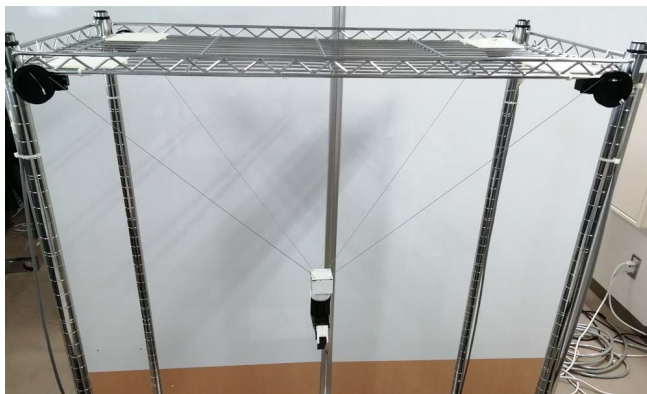
図 10: 試作したハンドの空中制御部
