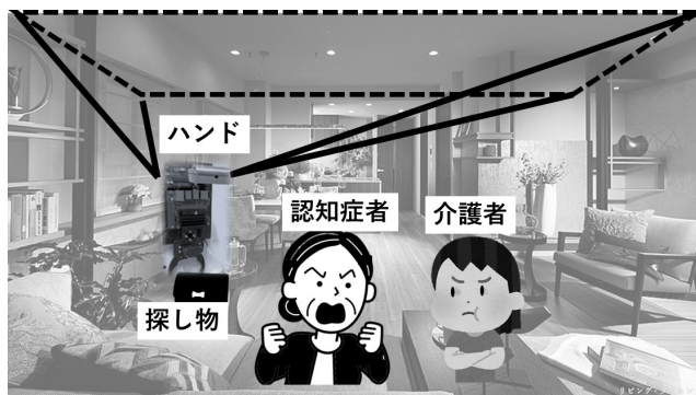
図 9: 平行ワイヤによるハンドの空中制御の概念
