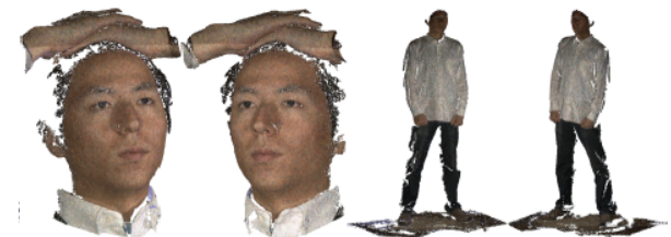
図-4 多視点画像を用いた人の形状復元結果例。高精度に顔、全身のデータを取得できている（[Furukawa, et al., TPAMI'10] より引用）
