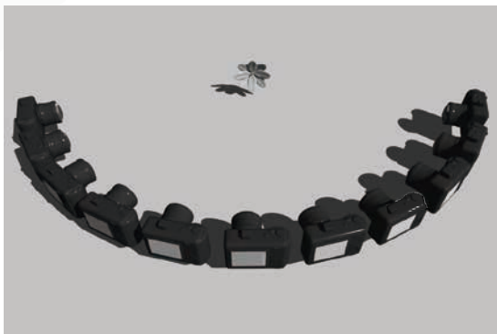
図-2 多視点カメラシステムのイメージ図。対象物（花）を囲むように配置された例
