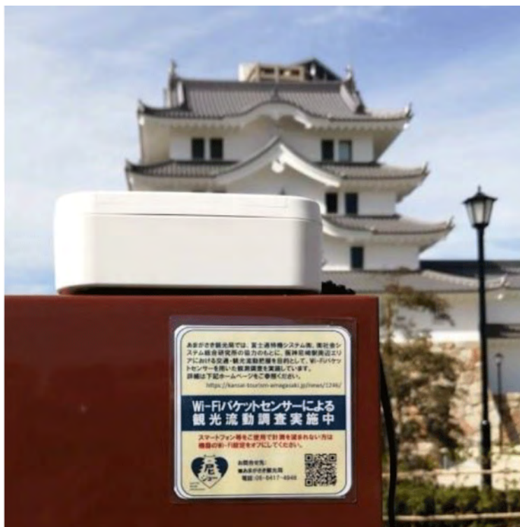
図1 尼崎城に設置されたセンサ (L150×W150×H55mm)
