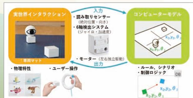
図-3 toio の絶対位置を使った動作の原理
