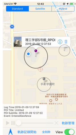
図 4: バーチャル・ジオフェンスを設置したアプリ画面例
