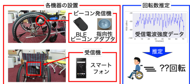
図 1 機器の設置と電波の受信及び判定
