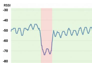
図2 人が寝ている際の受信電波強度の変化
