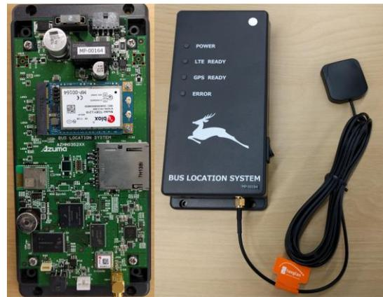
図 4 車載器(左:本体内部 右:本体外観と GPS アンテナ)
