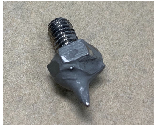
図 4: 実際に使用したボールキャスト。0.5 mm 径のボールペンの先端を使用している。
