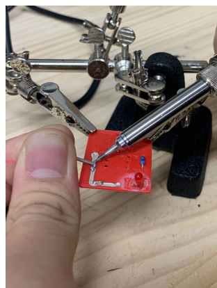
(b) 低融点半田を使用しているため、PLA樹脂で造形した基材に対しても半田付けが行える。
