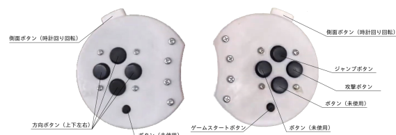
図 5 コントローラのボタン配置
