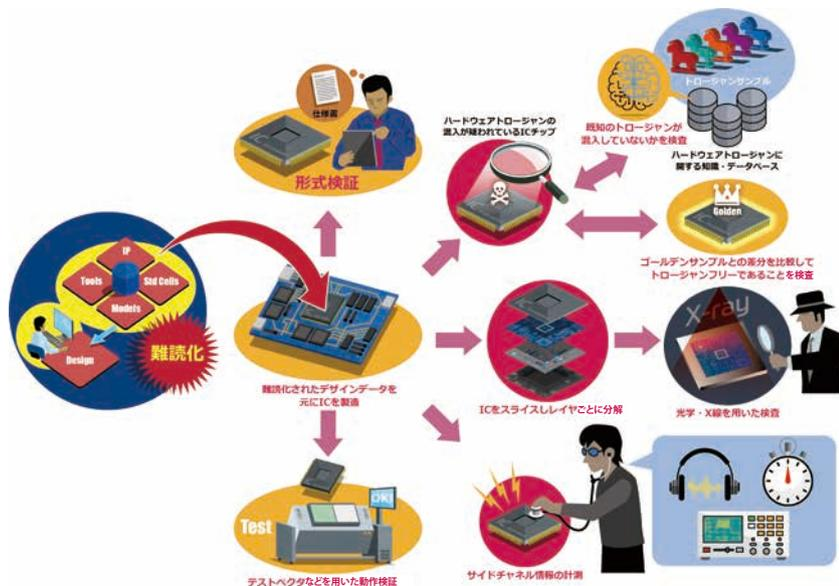
図-4 ハードウェアトロージャンの検出および挿入困難化手法<sup>3)</sup>
