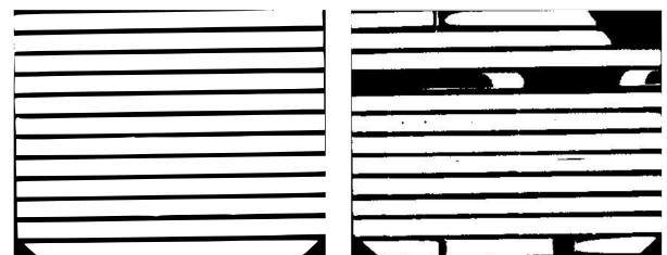
(a) 未破損すのこ表面の二値画像 (b) 破損すのこ表面の二値画像
