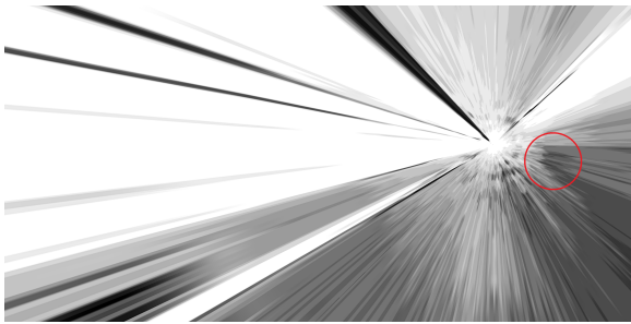
図 9 風の強さマップ．さざ波の顕著さ画像に，水面を真上から俯瞰して見たような変換を施し，マップ上に風の強さを可視化した．
