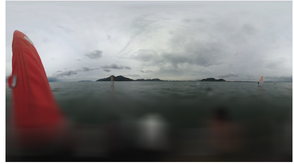
図 5 水面領域を平滑化した画像. 各画素値が風の強さの情報を持つように水面領域を一定の面積ごとの大きさのカーネルサイズの平均値フィルタによって平滑化した.
