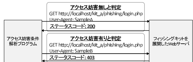
図1 閉環境のWebサーバに展開したフィッシングキットの動的解析の概要
