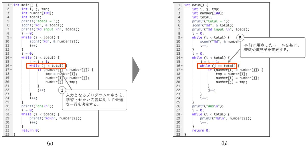
図 1 本研究の概要. 教育者が身に付けさせたい学習内容 (例: 条件分岐) を基に入力ソースコード (a) に対し, エラーを自動挿入することで, 間違い探し問題 (b) を生成する.
