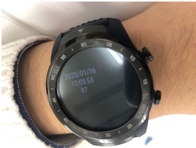
図2 実験参加者につけられたウェアラブル端末 実験時の日付, 時刻, 心拍数を表示, 送信する
