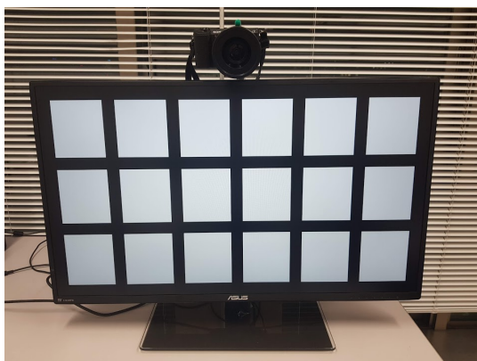
図 2: 提案するシステムのハードウェアの構成. 本システムは, 高画質カメラ, 液晶ディスプレイモニター, NVIDIA の GPU を搭載した PC から構成される. カメラはモニターの上部に設置し, USB ケーブルで PC に接続してある. カメラは PC から操作可能であり, 撮影した画像を PC に転送することができる. モニターには, 目の乾燥状態を判別するために目に映すグリッドパターンの画像を表示する. 256 × 256 ピクセル分の目の領域を切り取る.
