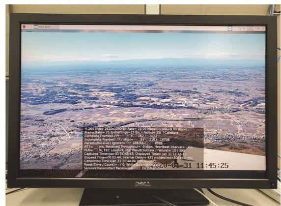
図 3 受信側画像の OpenVG による情報オーバーレイ事例
