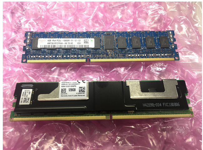
図 1 DIMM (写真上) と Optane DCPM (写真下) の比較
