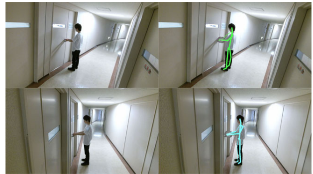
図 2 Kinect で取得した鍵開け時の RGB 画像と骨格座標 Fig. 2 RGB and joints images by Kinect on unlocking with key.
