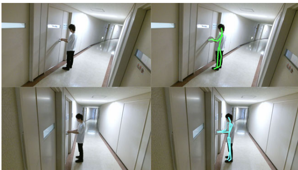
図 1 Kinect で取得したピッキング時の RGB 画像と骨格座標 Fig. 1 RGB and joints images by Kinect on picking.
