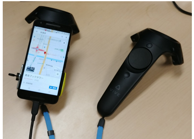
図 7 スマートフォンを VR コントローラに固定することにより端末をトラッキング
