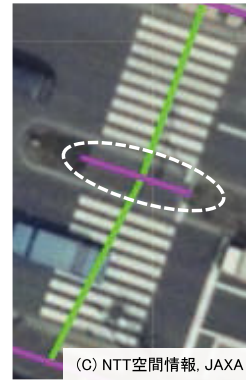
図 22 歩道中心線（人が進行する方向）と幅員が正しく抽出できないケース
