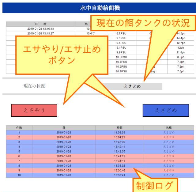
図 5 制御用スマートフォン上で操作する Web アプリのキャプチャ画面
