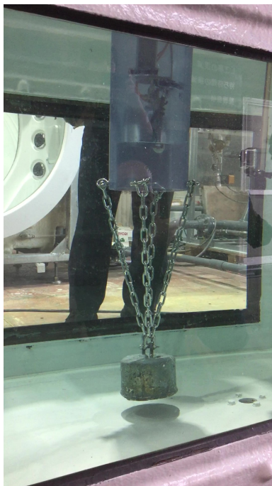
図 3 水中給餌装置のプロトタイプの外観
