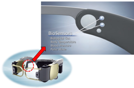
図 1 耳朶脈波センサを搭載したウェアラブル型デバイス。
