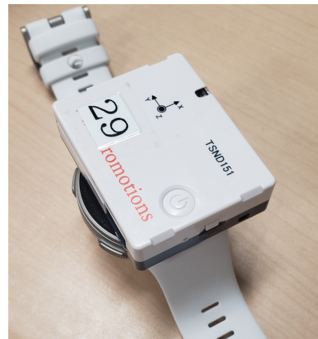
図4 慣性センサ TSND151 を装着した様子
