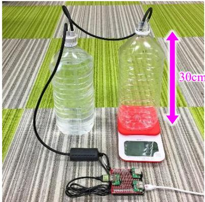
図18 ポンプの個体差評価実験の様子
