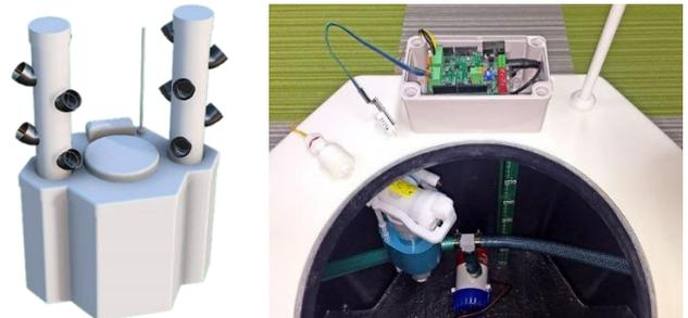
図2 小型水耕栽培装置の外観(左)と内部機構(右)
