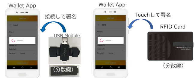
図2 分散値からの秘密鍵再生においては、分散値を格納するデバイスにより分散値取り込み方法が変わる。
