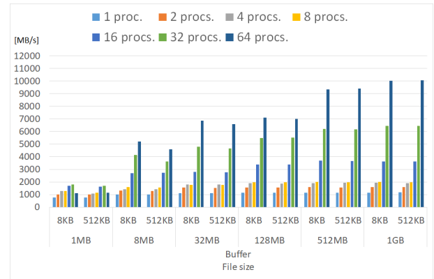
図 28 VH offload を用いた C 言語の fwrite 性能 (A300-8)
