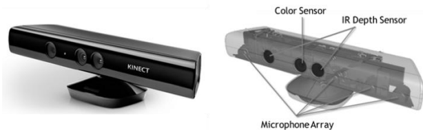
図 2: Kinect の構造と外観
