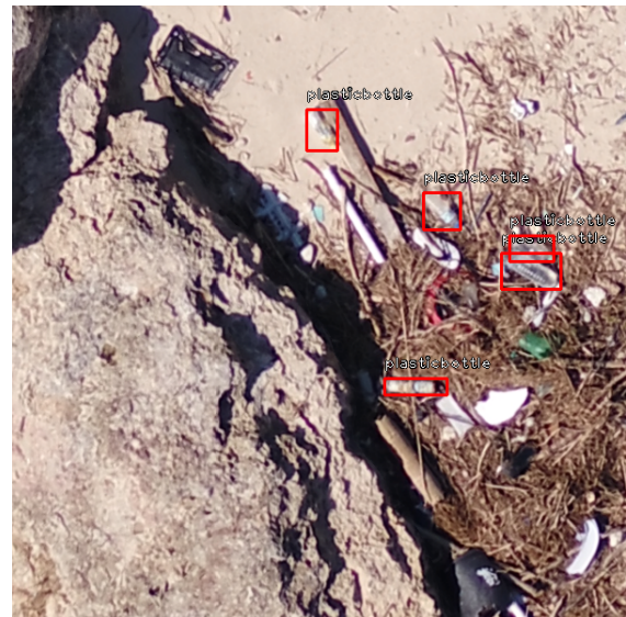
図 3 20m での予測結果：Komesu のうちペットボトルがある 12 枚の画像でテストを行なった可視化画像を 600×600 で切り取った。赤枠で囲まれているものがペットボトルである。
