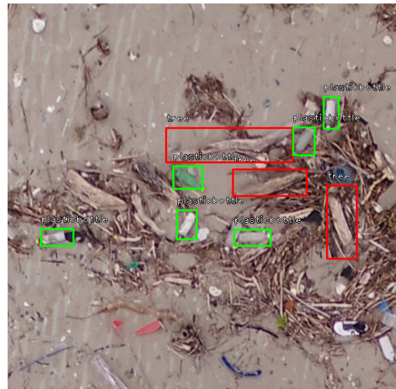
図 4 3 つのクラスで学習したモデルの検出結果: 緑で囲まれているものがペットボトルで, 赤で囲まれているものが流木.
