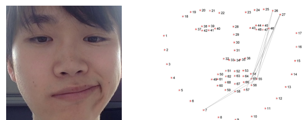
(a) 左口角を上げる顔の画像 (b) 特徴的な顔の 2 点間距離 図 3 左口角を上げる顔の動きにおける特徴的な顔の 2 点間距離
