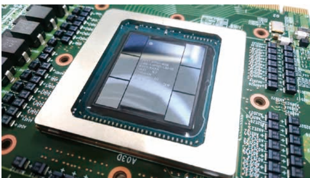
図-6 VE の構成：ベクトルチップ写真 (左) とシステムアーキテクチャ (右)
