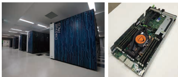
図-2 Oakforest-PACSの外観(左)と計算ノードの内部(右)
