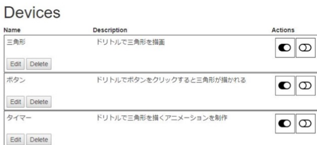
図 5 Node-RED Alexa Home Skill Bridge[9] にチュートリアルのコンテンツを「Name」として登録する画面。「Actions」の 1 列目はオン、2 列目はオフという機能をコンテンツが持つことを表す。
