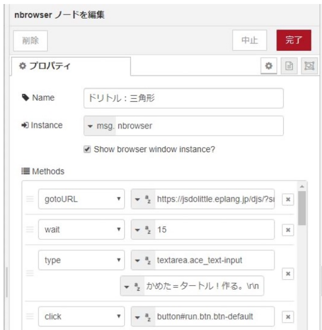
図 7 nbrowser[7] の編集画面。「gotoURL」は自動で Web サイトにアクセスするための機能で、開きたい Web サイトの URL を入力する。「type」は開いた Web サイトに自動で文字を入力する機能で、入力したい場所と文字を定義する。「wait」は後続の命令の実行を待機する。「click」は任意のボタンを自動でクリックする機能で、「type」と同様にクリックしたいボタンの場所を指定する。
