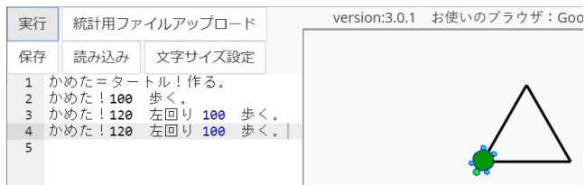
図 9 三角形コンテンツでユーザーに習得させたいソースコード。
