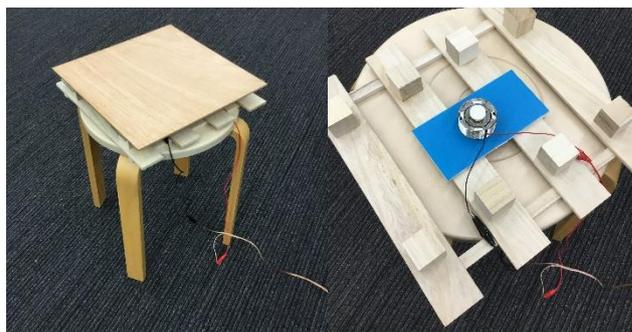
図 3 振動再現装置の外観とエキサイタ
