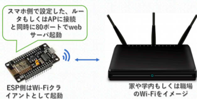
図 4 ESP と Wi-Fi ルータ又は AP の接続
