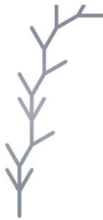
図12 F \rightarrow F[+F][-F] の書き換え規則による図形の生成
