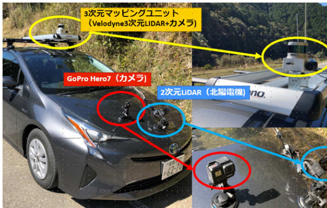
図 2 各種 LiDAR センサと動画カメラを搭載した車両
