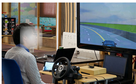
図4 ドライビングシミュレータ Figure 4. Driving simulator for evaluating user interface.
