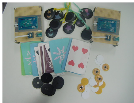
図2 第2世代のRFIDシステム(FeliCa)。
