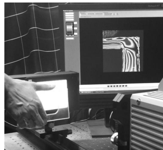
図 5 加圧時のエポキシ樹脂の内部応力分布
