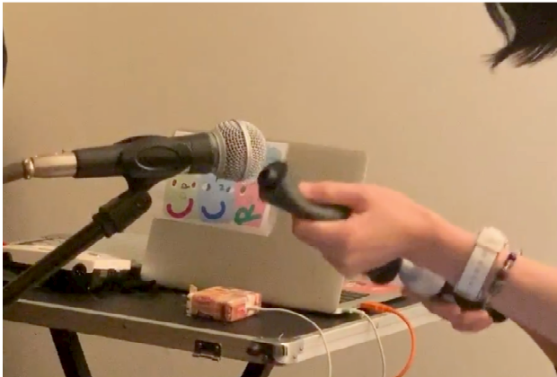
図 2 声道模型と電気式人工咽頭を用いたパフォーマンス
