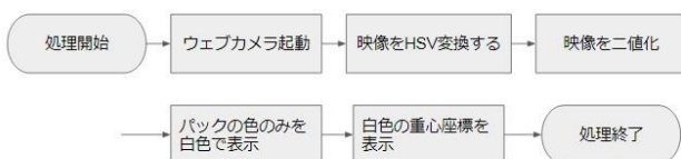
図3 追跡プログラムの流れ Fig.3 Flow of tracking program
