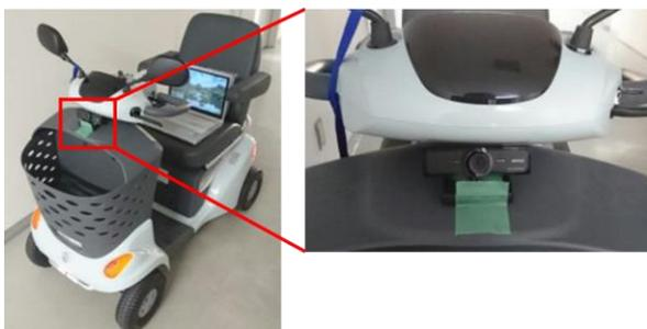
図2 Webカメラの取り付け位置。
