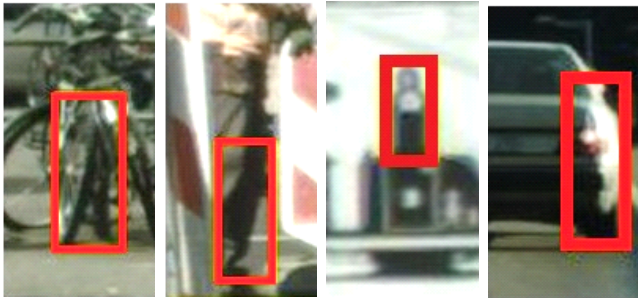
図1 超解像が原因となり発生する誤検出の例。左から自転車の一部、人の足、広告の一部、車の一部を人として誤検出している。このような誤検出は、超解像が不完全であるために超解像画像に発生するボケや歪みなどが原因であると考えられ、人がいるはずのない領域に対して過剰に高い超解像倍率により拡大を行った場合に多く発生する。
