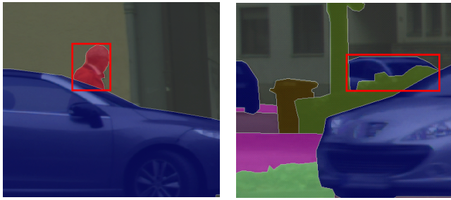
図 8 算出されるバウンディングボックスの高さが遮蔽によって小さくなってしまっている物体の例。本来は、遮蔽されている部分も考慮して全身を囲うようなバウンディングボックスが与えられるべきであるが、セグメンテーション用のデータセットは遮蔽を表現することはできないため、このようなバウンディングボックスが算出されてしまう。
