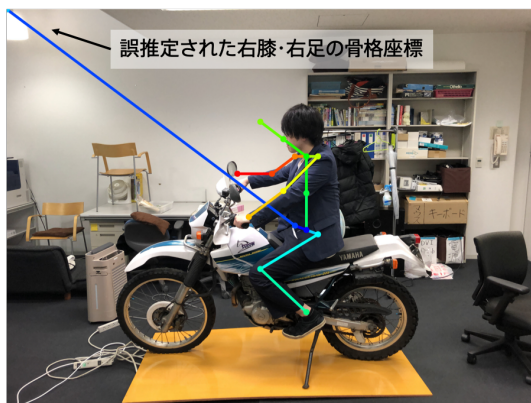
図 1 誤推定の例 (右膝・右足が車体で隠れている)
