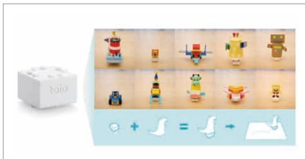
■図-2 おもちゃや工作を載せてキャラクタが自在に変わるキューブ型ロボット toio コアキューブ
