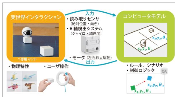
■図-3 toio の制御構造
